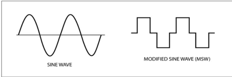
La plupart des multimètre n'arrive pas à lire le voltage RMS de l'onduleur a onde sinusoïdale modifiée, utilisez un multimètre identifiés "True RMS".
