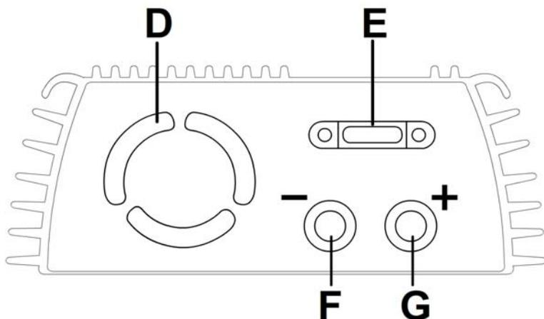
D. Ventilateurs a Haute vitesse de refroidissement. Lorsque la température à l'intérieur de l'onduleur dépasse une limite prédéterminer, le ventilateur de refroidissement s'allume automatiquement pour refroidir l'onduleur. Lorsque la température diminue, le ventilateur s'éteindra.
