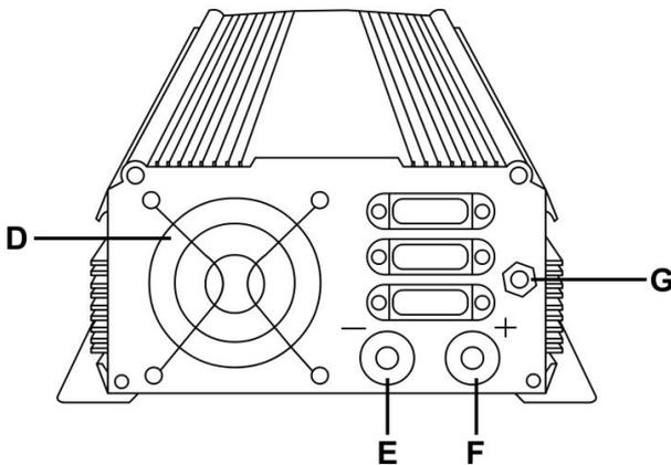
D. Ventilateurs a Haute vitesse de refroidissement. Lorsque la température à l'intérieur de l'onduleur dépasse une limite prédéterminer, le ventilateur de refroidissement s'allume automatiquement pour refroidir l'onduleur. Lorsque la température diminue, le ventilateur s'éteindra.
